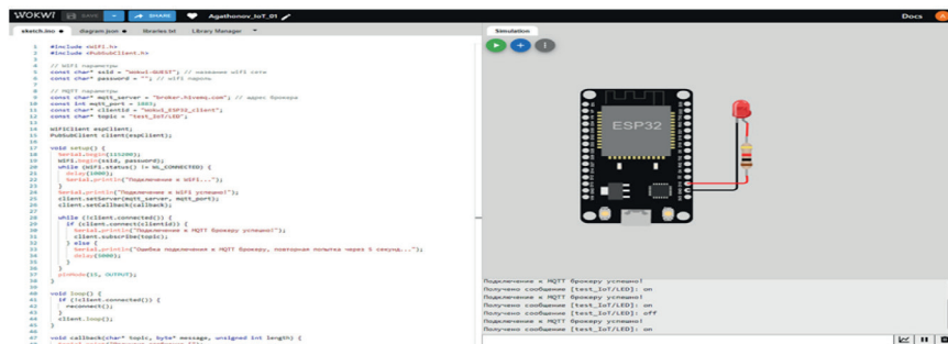
Рис 1. Пример образовательного проекта для демонстрации возможностей взаимодействия IoT устройств по протоколу MQTT, выполненный в онлайн симуляторе Wokwi. https://wokwi.com/projects/363884918001380353
